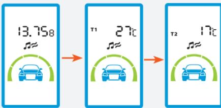
\*Измеряемые значения напряжения АКБ, температуры салона и температуры двигателя носят только информационный характер, по которым можно косвенно судить о измеренных параметрах (StarLine A93 v2, A63 v2, A39 v2, A36 v2 не является измерительным прибором). Контроль температуры двигателя возможен только при подключенном к комплексу датчике температуры двигателя. Датчик температуры двигателя в комплекте только StarLine A93 v2, A39 v2.
