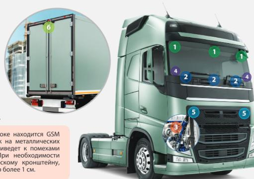
**3 Датчик температуры** двигателя закрепите на патрубке системы охлаждения рядом с блоком двигателя.
