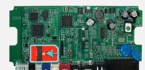
**3** Установите плату в корпус и закрутите 4 винта.
